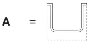
**A:** il cosiddetto "guscio", ovvero la vasca che non necessita di pannelli ma che viene incassata a pavimento.
