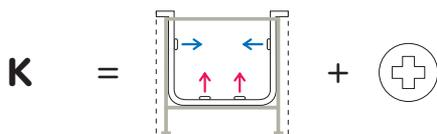
**K:** vasca con sistema idromassaggio e airpool, con sanificazione
