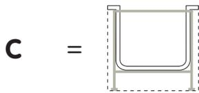
**C:** vasca con telaio in acciaio zincato e piedini di supporto; può essere dotata di pannelli (optional)
