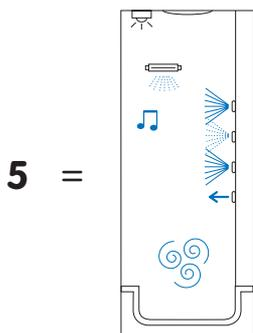
**5:** è' la versione TOP. Idrocabina con Back Rain, idromassaggio dorsale, quello cervicale ed il bagno di vapore. Con luce interna e radio.
